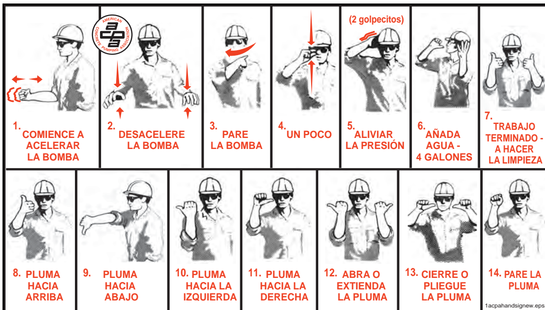
Figura 97 Señales de mano recomendadas por la ACPA (Asociación Americana de Bombeo de Concreto)
