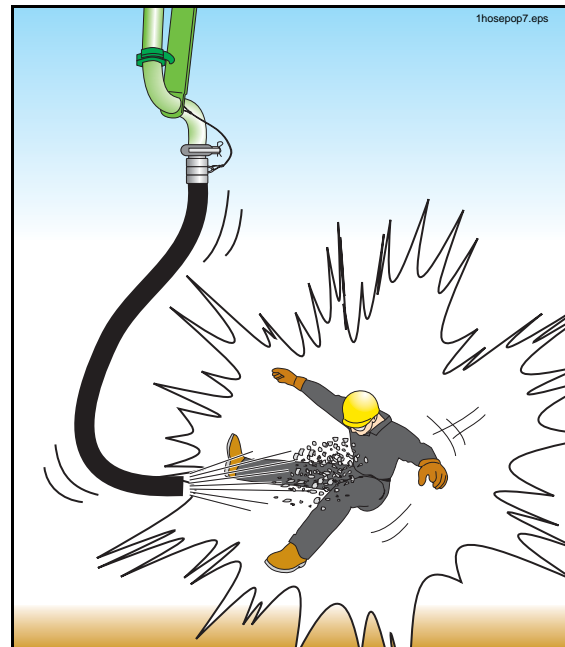
Figura 80 Advierta a todos los que se encuentren en el área de descarga que se alejen cuando se arranca la bomba por primera vez, se arranca después de moverla o si entró aire en la tubería
