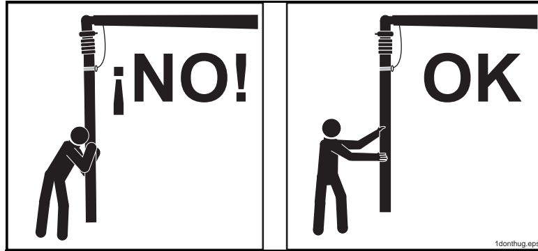
Figura 92 No agarre la manguera de la pluma de distribución abrazándose a ella
